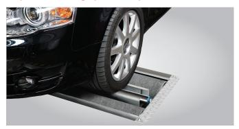
Soulevé des rouleaux au niveau du sol, le véhicule peut facilement sortir ou entrer dans le banc de freinage. Il n'y a ainsi aucun risque d'endommager les dessous de caisse des véhicules avec un châssis sport, une garde au sol basse ou un petit diamètre de roue.
