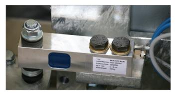
Les valeurs de contrôle sont déterminées à l'aide du principe éprouvé des jauges de contrainte. Ce système de mesure inusable garantit des mesures fiables et exemptes d'erreurs des forces produites.
