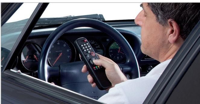
Mit der optionalen Funk-Fernbedienung können die Prüfgeräte vom Fahrzeug aus bedient werden, z. B. kann nur der Bremsprüfstand gestartet oder die Prüfreihenfolge beliebig vorgenommen werden.
