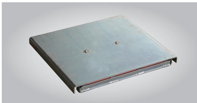
Mit dem Schnellspurtester kann die Spurabweichung des zu testenden Fahrzeugs gemessen werden. Es erfordert keinen zusätzlichen Prüfaufwand, da die Prüfplatte direkt vor dem Fahrwerkstester oder Bremsprüfstand platziert und einfach überrollt wird. Die korrekte Diagnose der Vor- und Nachspur erfolgt über die automatische Messwert-erfassung. Der Messwert wird in  $0 \pm 20$  mm/m angezeigt.
