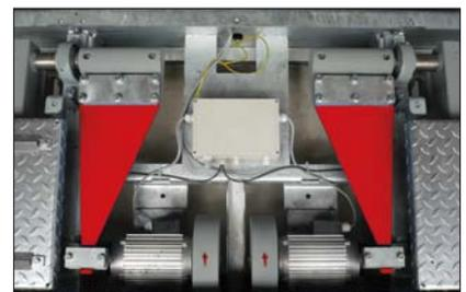
Il sistema a masse oscillanti del banco di prova è progettato ad hoc per le oscillazioni risonanti delle sospensioni dei veicoli.
