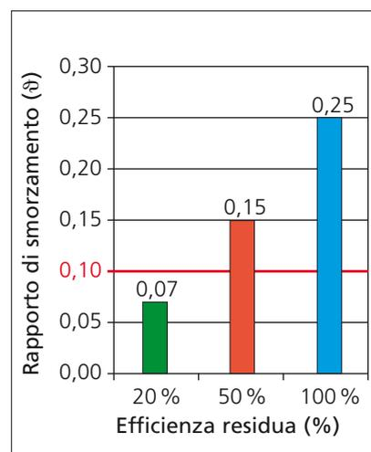
Rapporti di smorzamento  $\vartheta$  determinati con il prova sospensioni FWT 3800 per ammortizzatori con differente efficienza residua; i valori sono determinati montando gli ammortizzatori sullo stesso veicolo.
