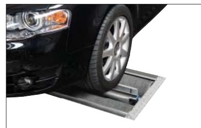
Обеспечивает подъем автомобиля на уровень пола, что облегчает въезд и выезд с роликов. Автомобили со спортивной подвеской, малым клиренсом и малыми колесами можно испытывать без всякой угрозы повреждения днища автомобиля. Внимание: требуется подготовка соответствующего фундамента и подвод воздуха с давлением 8 бар.
