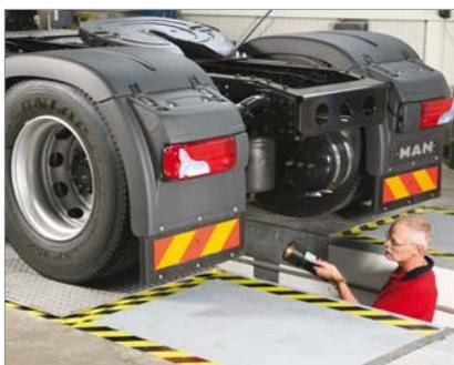
Le dispositif de contrôle du jeu des rotules est un complément judicieux pour la réception ou l'inspection, afin de procéder à un contrôle visuel du jeu des essieux. Les plaques de contrôle galvanisées sont déplacées hydrauliquement en appuyant sur le témoin lumineux. Les plaques de contrôle peuvent être commandées individuellement dans le sens opposé (4 courses) ou dans le même sens (8 courses).
