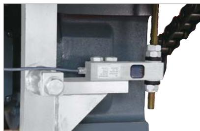
L'enregistrement des valeurs de contrôle à déterminer est réalisé à l'aide de jauges de contrainte. Ces capteurs de mesure inusables déterminent avec fiabilité et précision les forces générées.
