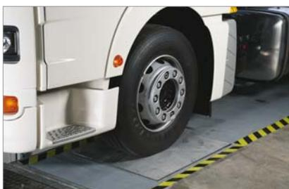
Ce dispositif permet de mesurer le ripage du véhicule. Le résultat de pincement positif ou négatif des roues s'affiche sur les DEL intégrées (option) de l'afficheur analogique ou sous forme d'un graphique à l'écran optionnel.
