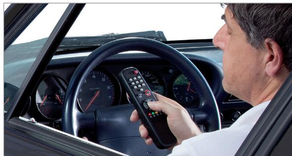
Il telecomando a radio frequenza permette il completo controllo dell'apparecchiatura da parte dell'operatore, rimanendo al posto di guida del veicolo. La possibilità di programmazione del canale radio garantisce la non interferenza con altri dispositivi.
