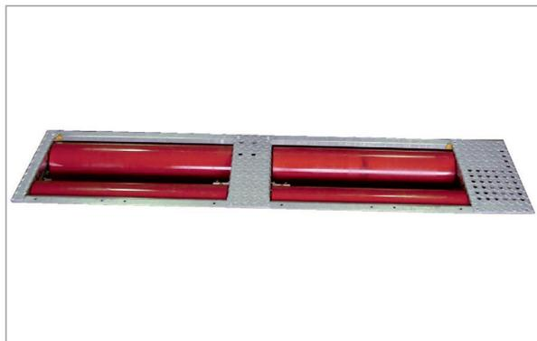
Il banco prova velocità misura la distanza, il tempo di prova, la velocità di prova corrente e la velocità massima di ciclomotori a 2, 3 e 4 ruote fino a 80 km/h. Può inoltre essere usato, in combinazione con un analizzatore di emissioni, per il controllo gas di scarico su ciclomotori e motocicli omologati secondo il capitolo 5 della direttiva 97/24/CE.
