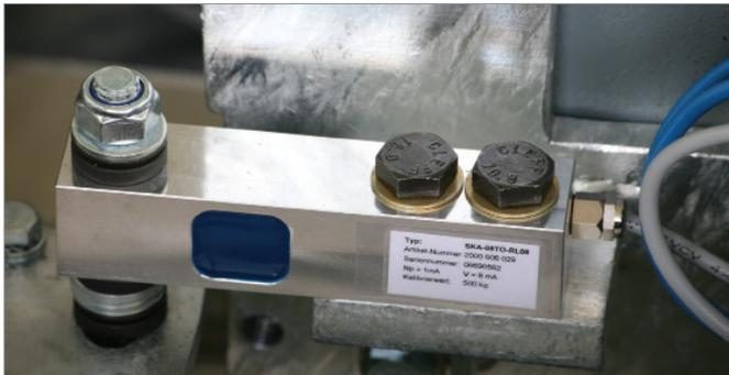
Die Prüfwerte werden über das bewährte DMS-Messprinzip erfasst. Diese verschleißfreie Messsensorik ermittelt zuverlässig und fehlerfrei die entstehenden Kräfte.
