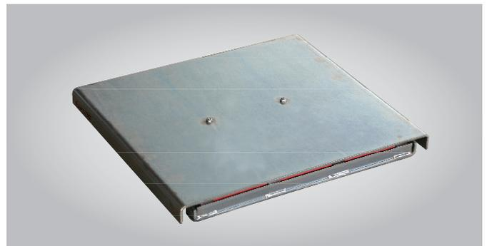
Mit dem Schnellspurtester kann die Spurabweichung des zu testenden Fahrzeugs gemessen werden. Es erfordert keinen zusätzlichen Prüfaufwand, da die Prüfplatte direkt vor dem Fahrwerkstester oder Bremsprüfstand platziert und einfach überrollt wird. Die korrekte Diagnose der Vor- und Nachspur erfolgt über die automatische Messwert-erfassung. Der Messwert wird in  $0 \pm 20$  mm/m angezeigt.
