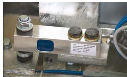
Измерение параметров выполняется тензометрическими датчиками. Эта безинерционная техника обеспечивает надежные и точные измерения силовых параметров.
