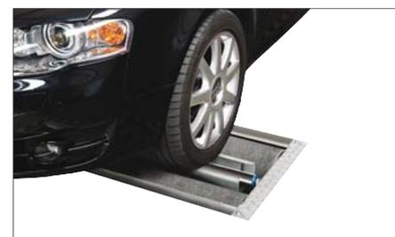
При поднятом устройстве въезд и выезд со стенда облегчается, особенно для автомобилей со спортивной подвеской, с малым клиренсом или с малыми колесами. Примечание: необходимо предусмотреть соответствующий фундамент и подвод воздуха 8 бар; управление только с ПДУ.
